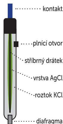
Argentochloridová elektroda
